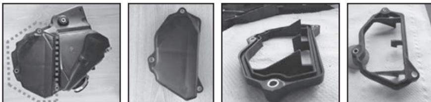
Le conduit d'entrée de la boîte à air peut être supprimé (pièce #28), les 2 trompettes d'admissions peuvent être réduites en longueur autant que souhaité (pièces #26 et #27).
